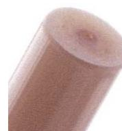
PEEKsil™ Kapillare deren Ende exakt rechtwinklig geschnitten und glatt geschliffen ist, was Totvolumen freie Verbindungen ermöglicht.
