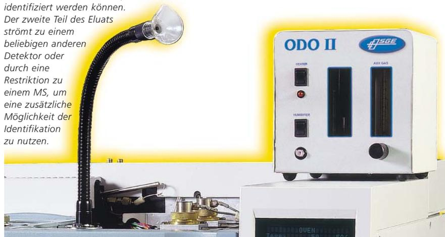
ODO II mit flexiblen Transferrohr, Nasenkonus aus Glas und Kontrollmodul.
