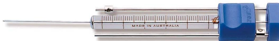
Die RA8 Repetierhalterung kann an alle 0,5µL bis 500µL Spritzen mit 8mm AD Glaskörper montiert werden. (Gezeigt wird hier eine 50µL Spritze mit RA8 Halterung.)
